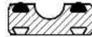
Перевернутый дисковый поплавок Сторона диска с бороздкой вверх Закрытие клапана при скорости воздуха 400 л/сек V1000 и 800 л/сек V2000
